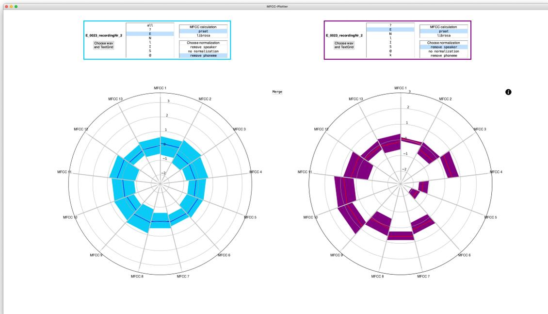
Abbildung 1: MFCC-Plotter: Linke Abbildung: 13 MFCCs von /E/ mit Praat berechnet, Phonem-Normalisierung; rechte Abbildung: 13 MFCCs von /E/ mit Praat berechnet, Sprecher-Normalisierung
